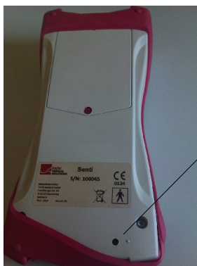
Fig. 3: Botón de reinicio negro situado en la parte posterior del dispositivo debajo de la estructura de goma roja
