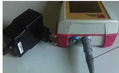
Fig. 10: Suministro eléctrico y cable de carga con tensión gris
