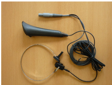
Fig. 12: Interruptor de respuesta de paciente con conductor óseo
