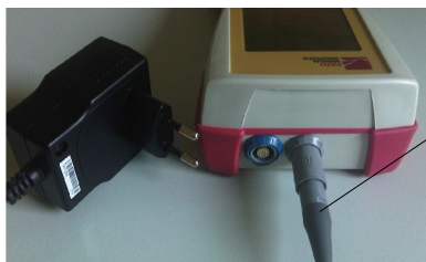
Abb. 10: Stromstecker bzw. Ladekabel mit grauer Knick- schutztülle
