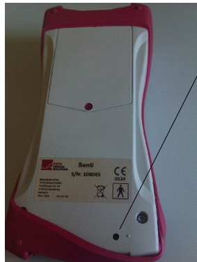
Abb. 3: Schwarzer Resetknopf auf der Rückseite des Gerätes unter der roten Gummimantelung
