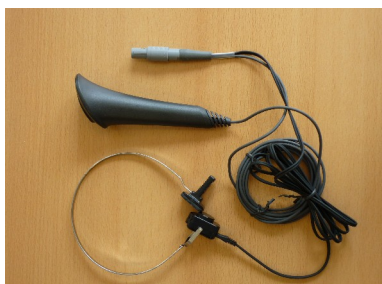
Fig. 12: Bouton de réponse patient branché avec le conducteur crânien
