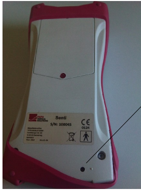
Fig. 3: Bouton noir de réinitialisation situé sous l'habillage en gomme rouge situé sur le socle de l'appareil
