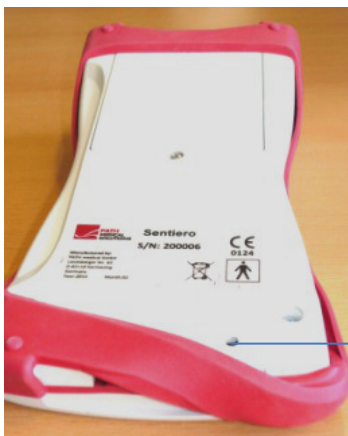
рис.3 Черная кнопка сброса на задней стороне устройства под красным резиновым корпусом
