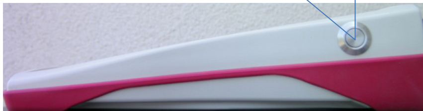
рис.2 Кнопка включения / выключения на правой стороне устройства. Специальные функции во время проведения тестов MAGIC и SUN
