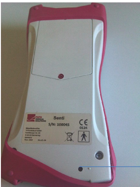
рис.3 Черная кнопка сброса на задней стороне устройства под красным резиновым корпусом
