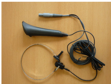
рис.12 Кнопка ответа пациента в комбинации с костным вибратором
