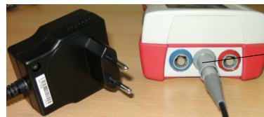
Fig. 13: Suministro eléctrico y cable de carga con tensión gris
