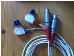
Fig. 5: Sonda OEA (TE: gris y DP: roja) con alivio de tensión roja
