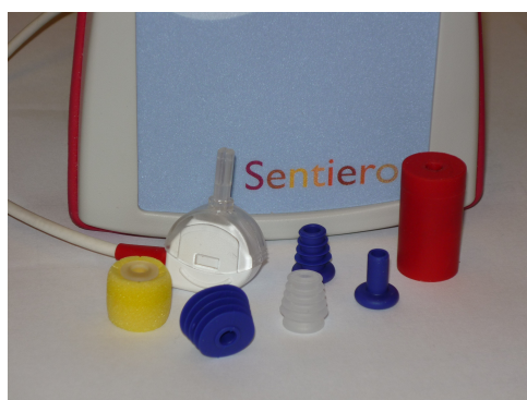
Fig. 23: Acoplador de prueba (derecha), sonda con punta de sonda montada, adaptadores de oídos (accesorios)
