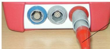
Sondenkabel (für OAE-Messungen) mit der roten Knickschutztüle
