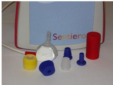
Abb. 24: Testkuppler (rechts), Sonde mit montierter Sondenspitze, Ear tips (Zubehör)
