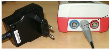
Abb. 13: Stromstecker bzw. Ladekabel mit grauen Knick-schutztülle
