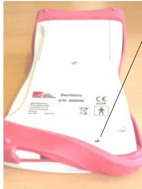
Mit einem Stift den Reset-Knopf drücken. Anschließend mittels Einschaltknopf Gerät einschalten
