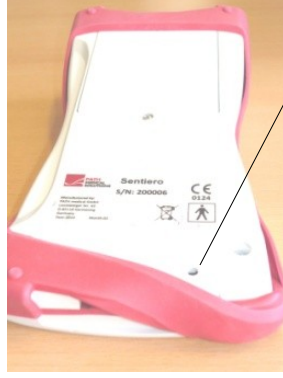
Şekil 3: Kırmızı lastik çerçevenin altında yer alan cihazın arka tarafındaki siyah reset butonu
