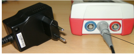
Fig. 13: alimentazione e cavo di carica con scarico tensione grigio
