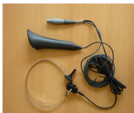
Fig. 15: interruttore di risposta paziente combinato con conduttore osseo
