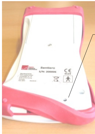
Fig. 3: Tasto reset nero sul lato nero del dispositivo sotto al telaio in gomma rossa
