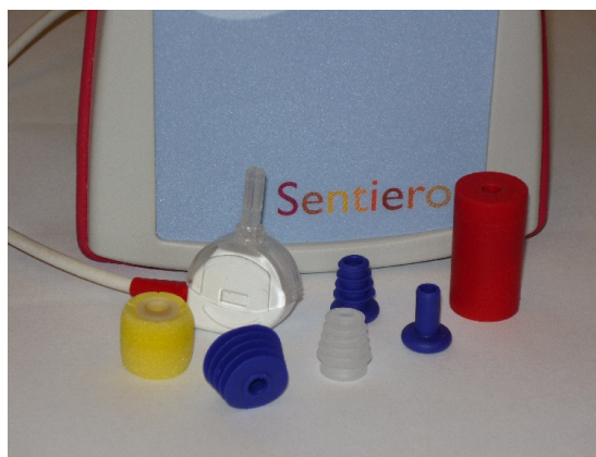
Fig. 24: accoppiatore test (destra), sondino con placchetta sondino montata, placchette auricolari (accessori)
