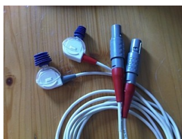
Fig. 5: Sonde auriculaire OEA (TE: grise et DP: rouge) avec indication de la tension en rouge
