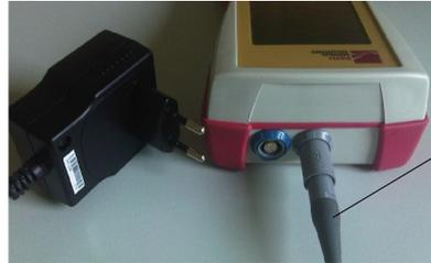
*Fig. 10: alimentazione e cavo di carica con scarico tensione grigio*
