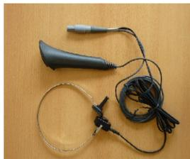
*Fig. 12: interruttore di risposta paziente combinato con conduttore osseo*
